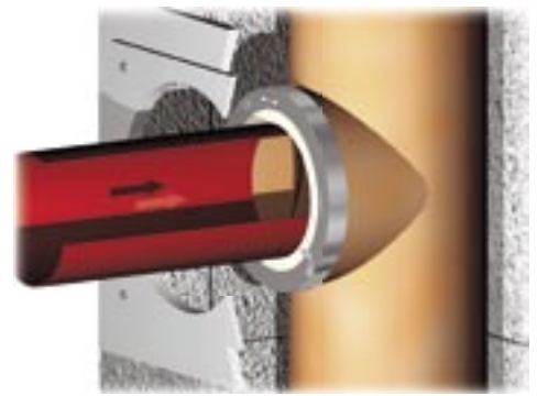
Detail Rauchrohr-Anschluss. Das Abgasrohr wird in den Anschluss eingeschoben.
