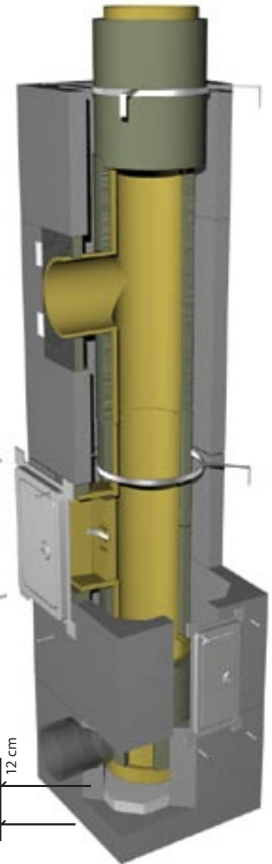
FBLASK-System Schnitt durch den unteren Teil mit PA und RA Der RA muß nicht in der selben Richtung eingebaut sein wie der PA! Die Revisionstür kann an einer beliebigen Seite platziert werden.
