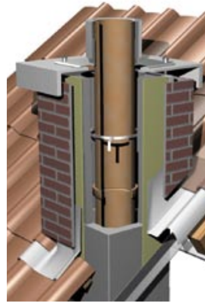
Aufbau mit Schornstein-Fertigkopf
