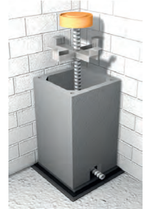
Detail Deckendurchgang Holzdecke (Vereinfacht)
