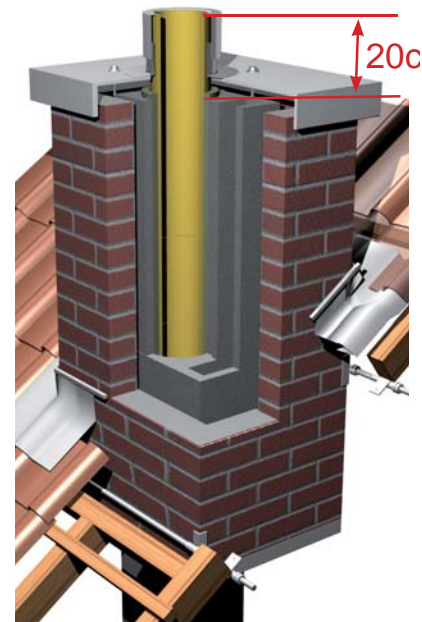
Schornsteinkopf, ummauert mit Sparrenhalter
